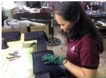
手で刺していく手刺し剣道具の垂を刺している様子
